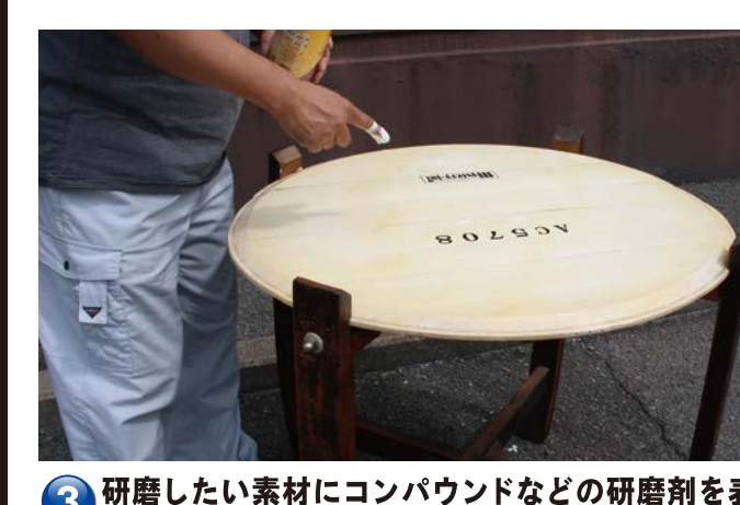
③ 研磨したい素材にコンパウンドなどの研磨剤を表面に塗ります。 ※スポンジバフファイブやウールバフに直接研磨剤をつけると目詰まりします。
