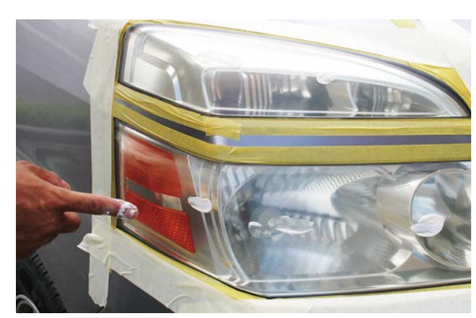
⑤ コンパウンドなどの研磨剤をライトの表面に塗ります。 ※ウールバフに直接研磨剤をつけると目詰まりします。
