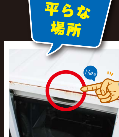
① 平らな場所のサビはウルトラソフトペーパーを使用して落とします。
