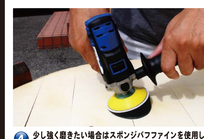
④ 少し強く磨きたい場合はスポンジバフファイブを使用します。スポンジバフファイブで研磨する場合は写真のように右側に傾けるように圧をかけ縦向きと横向きに研磨します。
